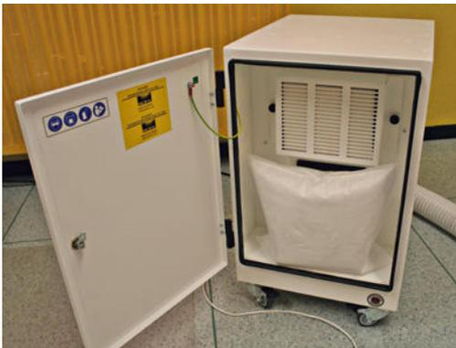
**6** „PODO pure+“ Absaugmotor mit HEPA-Filter und großem Taschenfilter. Deutlich sieht man die räumliche Ausdehnung des Filters mit sehr großem Fassungsvermögen für den Schleifstaub.
