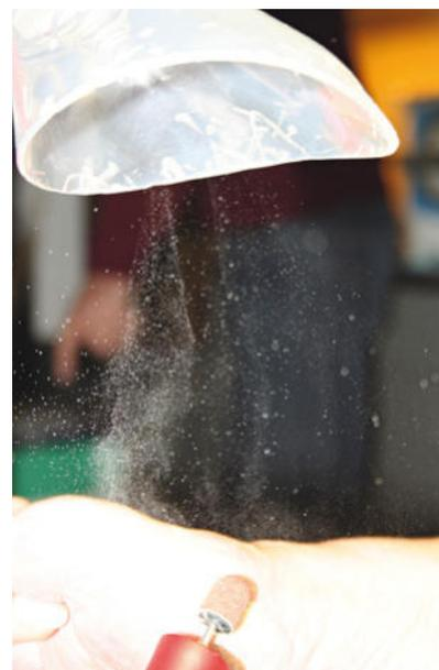
**4** Nahaufnahme der starken Wirkung der „externen“ Absauganlage.
